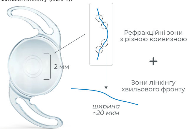
Мал. 1. Оптичний дизайн ІОЛ ELON з використанням технології Wavefront Linking.
