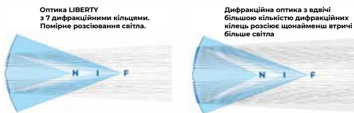
Мал. 4. Інтенсивність сірих ліній схематично показує кількість розсіювання світла, викликаного двома дифракційними схемами.
